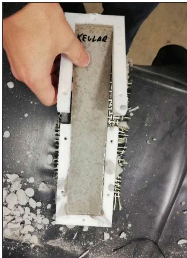
19. ábra: 3D nyomtatott zsaluzatok összeállítása (felső), zsaluzatok szétbontása (alsó)
