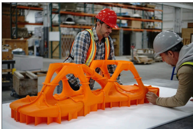
14. ábra: Nyomatott zsaluzat összeszerelése (ball) és roncsolásos kizsaluzás (jobb) (Delicate Density - R&D, 2022)
